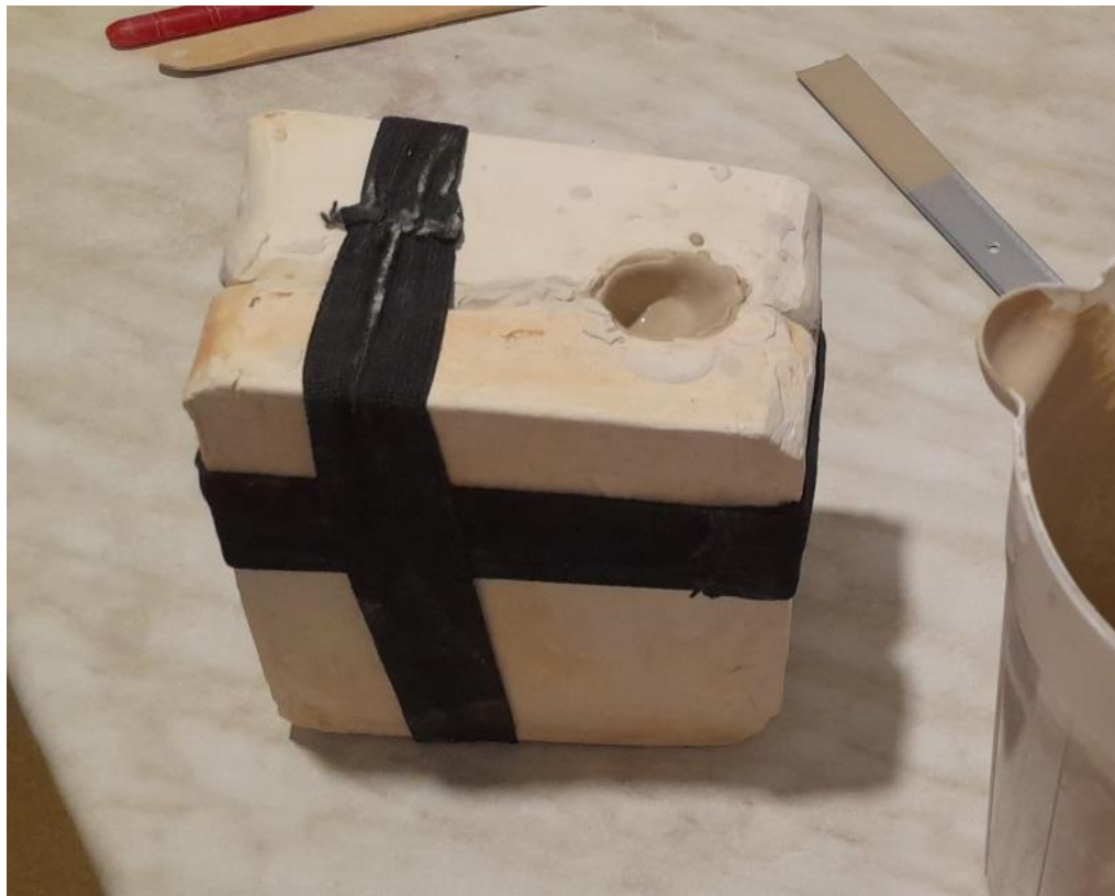
Рисунок 16. Заливка шликера в форму
