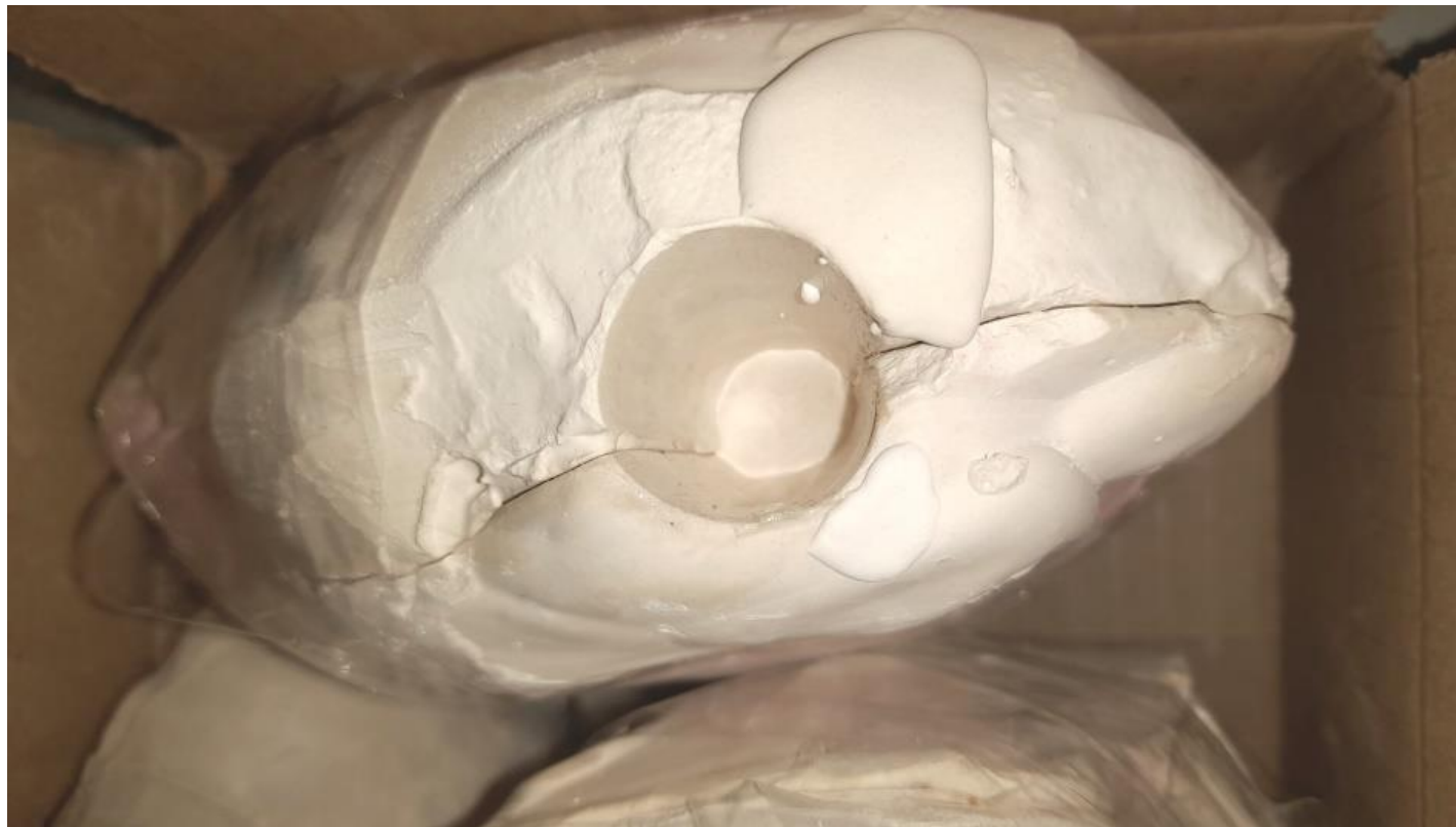
Рисунок 8. Заливка черновой формы гипсом
