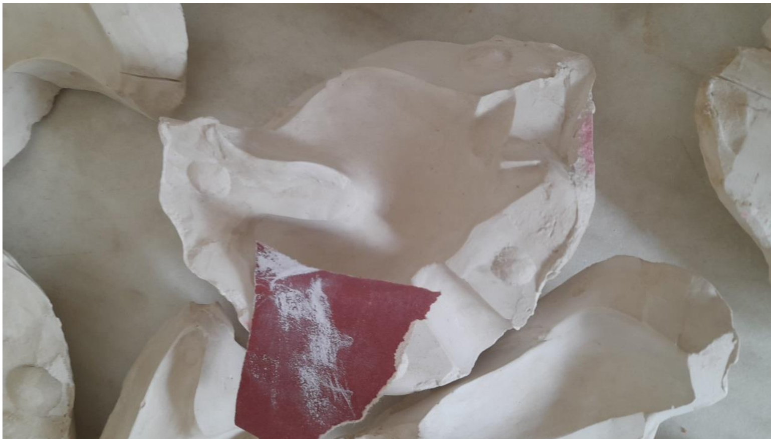
Рисунок 6. Выравнивание поверхности черновой формы
