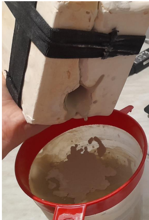
Рисунок 17. Сливание шликера из формы
