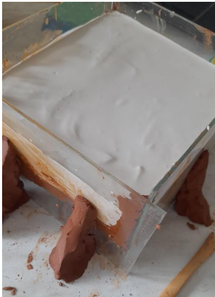
Рисунок 13. Заливка гипсовой смеси в опалубку
