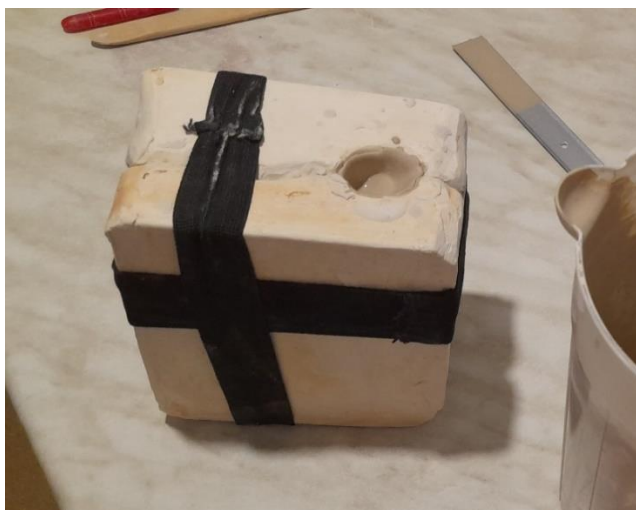
а – заливка шликера в форму
