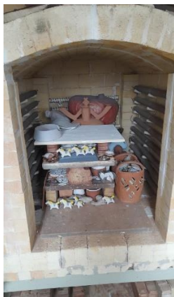
а – загрузка печи для обжига
