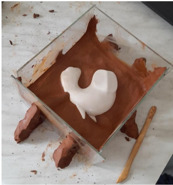
а – отливка чистой формы. Выставление опалубки
