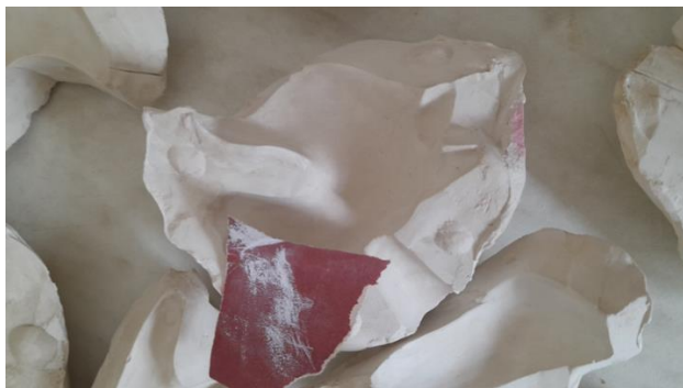
а – выравнивание поверхности черновой формы
