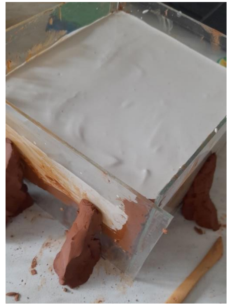
б – заливка гипсовой смеси в опалубку
