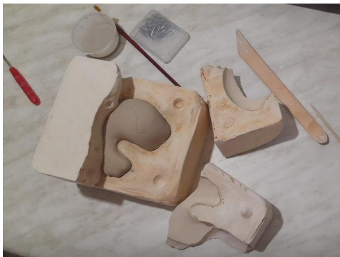
Рисунок 46. Разбор чистой гипсовой формы для выемки керамической фигурки
