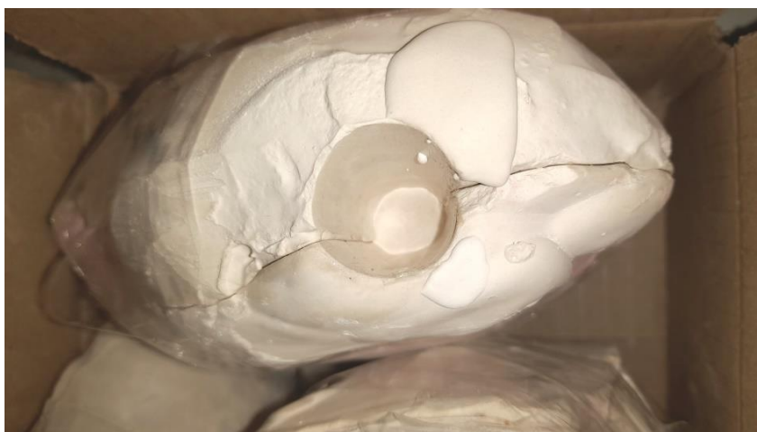
Рисунок 40. Заливка черновой формы гипсом
