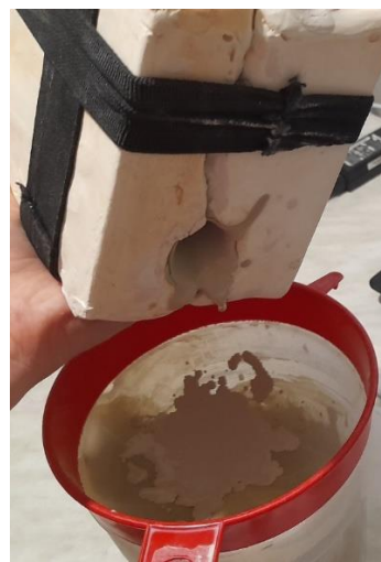
б – сливание остатков шликера из формы
